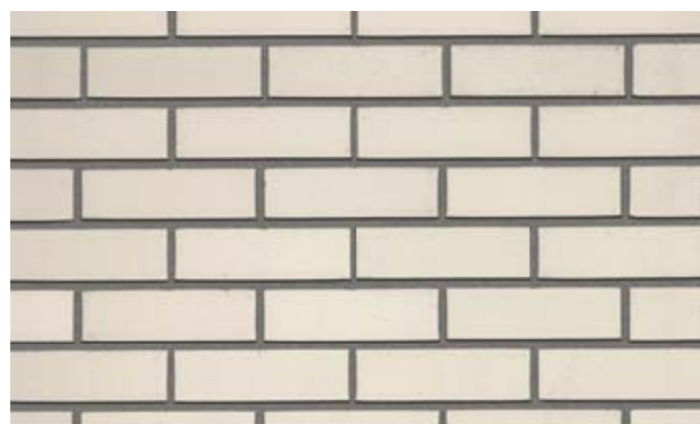
Waaldickformat WDF 210 x 65 mm ca. 61 Stück pro m 2 inkl. Fugen
