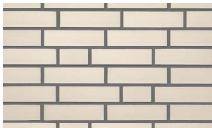
Reichsformat RF 240 x 65 mm ca. 52 Stück pro m 2 inkl. Fugen
