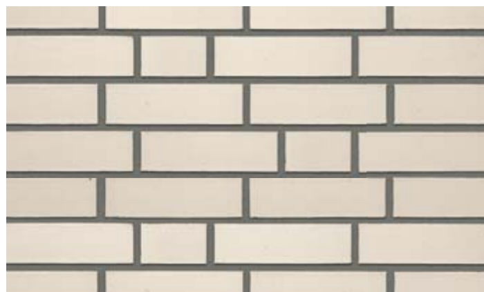
Normalformat NF 240 x 71 mm ca. 48 Stück pro m 2 inkl. Fugen
