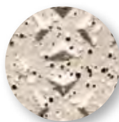
Поверхность с фактурными выступами «звездочки» (R 12-V4/B)
